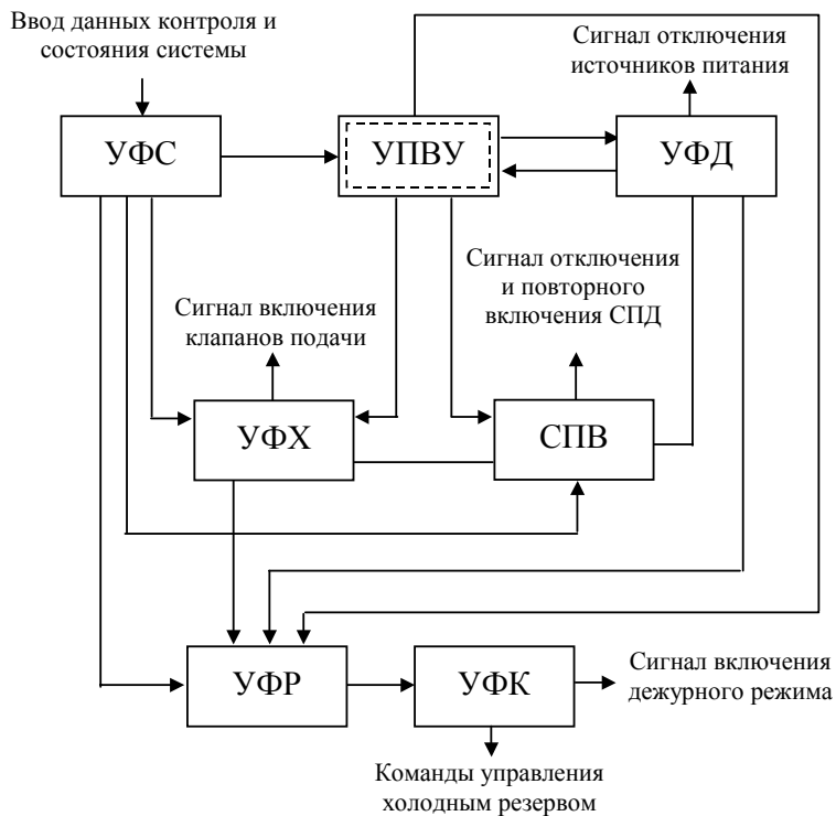
Обобщенная структурная схема устройства диагностики неисправностей ЭРДУ
