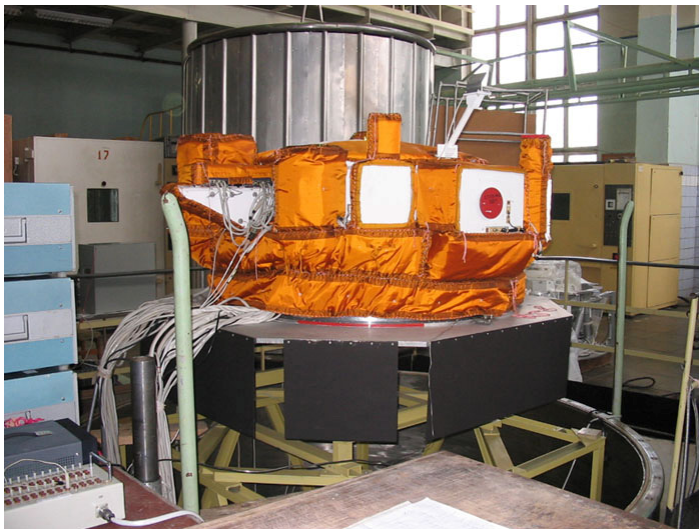
Рис. 2. Детекторы КНА «ФОТОН» перед тепловакуумными испытаниями
