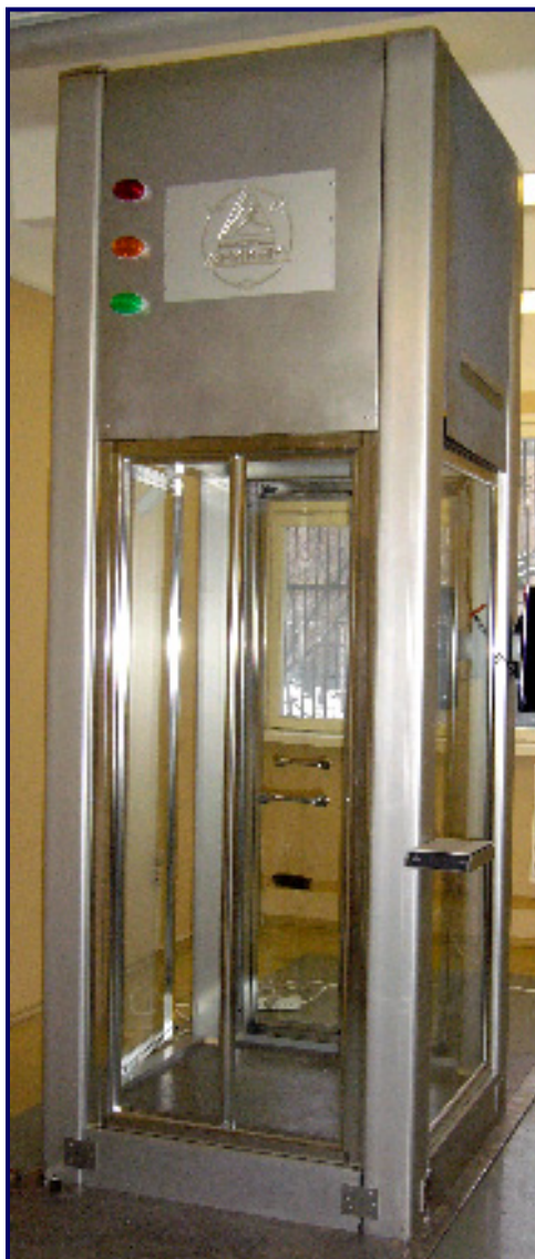
Рис. 10. Портальный монитор «ВНИИЭМ-ПМ», в верхней части которого установлен КГД
