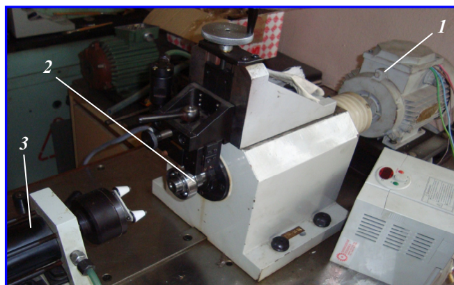
Рис. 1. Стенд МБ-184К: 1 – приводной двигатель; 2 – шпиндель с подшипником; 3 – нагружающее устройство
