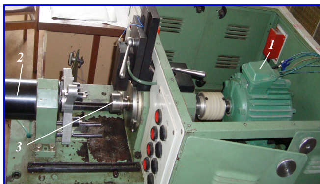
Рис. 2. Стенд ВНИИП 550: 1 – приводной двигатель; 2 – нагружающее устройство; 3 – шпиндель
