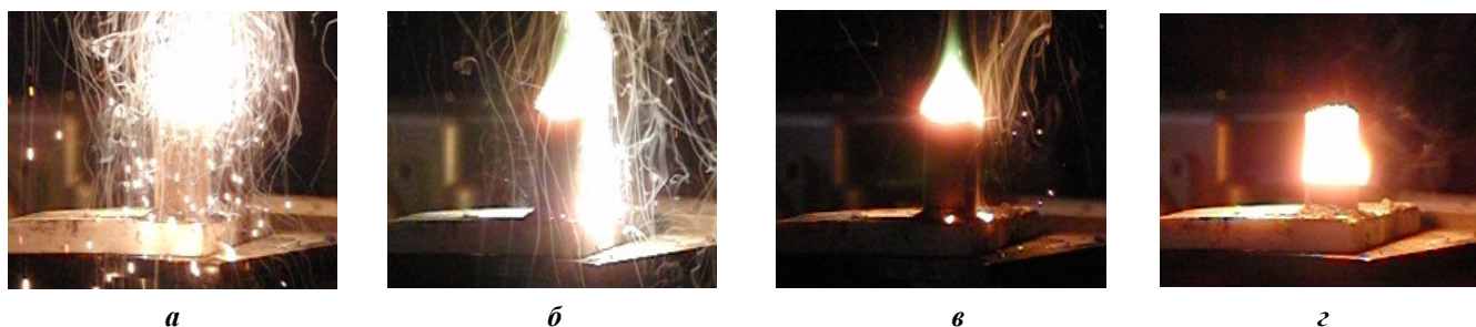
Рис. 9. Этапы получения кристаллов методом СВС: а – поджиг таблетки из шихты; б – начало эндотермической реакции окисления; в – развитие реакции окисления и формирование фронта кристаллизации; г – движение фронта кристаллизации, завершение реакции и остывание кристалла
