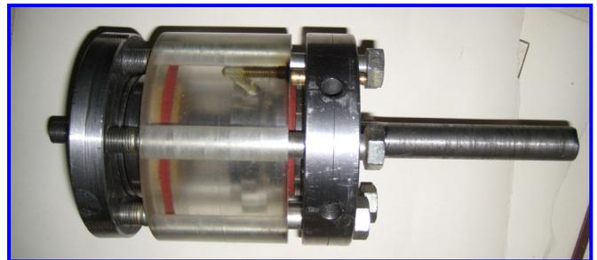
Рис. 5. Внешний вид ствольной секции электротермической пушки
