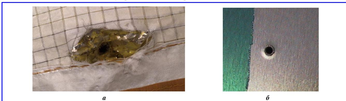
Рис. 2. Повреждение обшивки МКС микрометеоритами, зафиксированное 08.06.2007 г. (а), и корпуса модуля «Леонардо» (б) [9]
