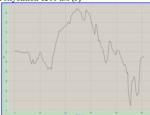
Рис. 13. Участок полированного образца кристалла ЛГС размером 50 \times 50 мкм ( a ) и профиль поперечного сечения дефекта – ямки глубиной 1300 нм ( б )
