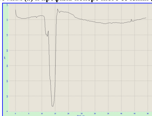
Рис. 12. Участок поверхности кристалла ЛГС размером 50 \times 50 мкм ( a ) и профиль поперечного сечения ( б )
