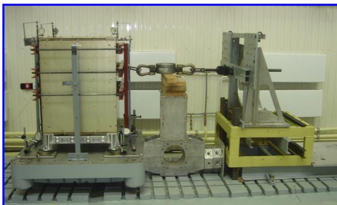
Рис. 2. Вид стенда статического нагружения с установленным динамическим макетом универсальной спутниковой платформы УСП-250
