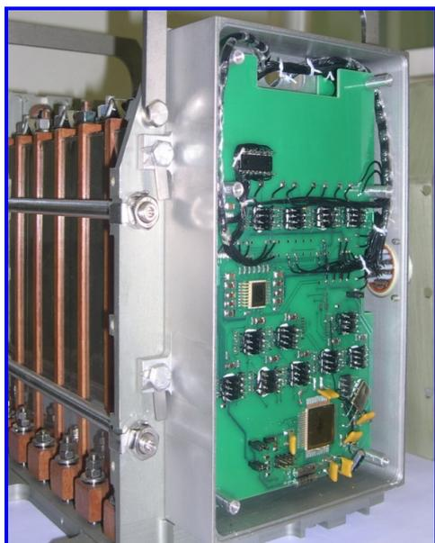
Рис. 3. Блок контроля и управления батареями из семи ЛИА с током подзаряда до 10 А
