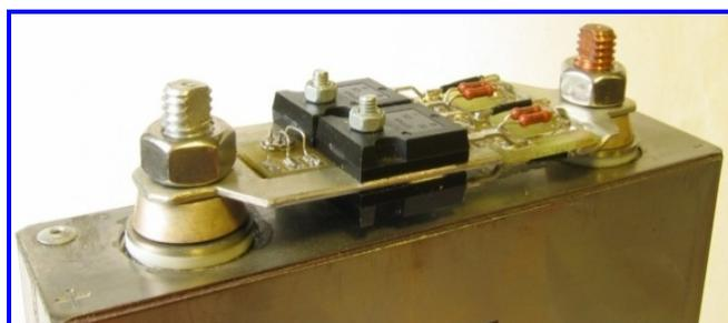
Рис. 2. Модуль выравнивания и коммутации
