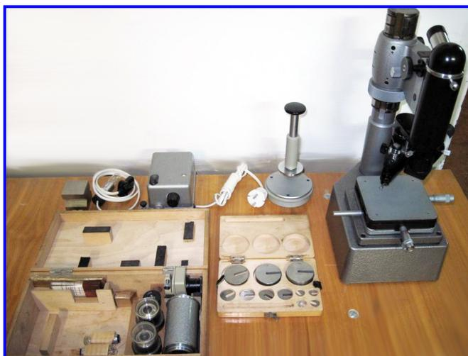
Рис. 1. Микротвердомер типа ПМТ-3 с набором калиброванных грузов и насадок
