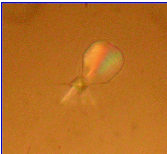
Рис. 11. Отпечаток индентора Виккерса (ПМТ-3) на X-срезе монокристалла ЛГС,  $P = 0,04$  кг
