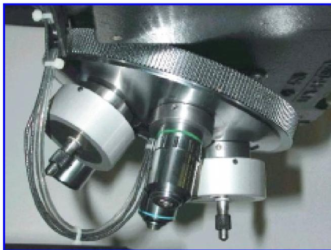
Рис. 5. Автоматическая поворотная турель микротвердомера Tukon-2100
