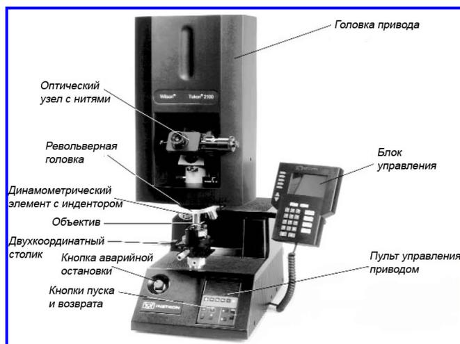
Рис. 4. Автоматический микротвердомер Tukon-2100
