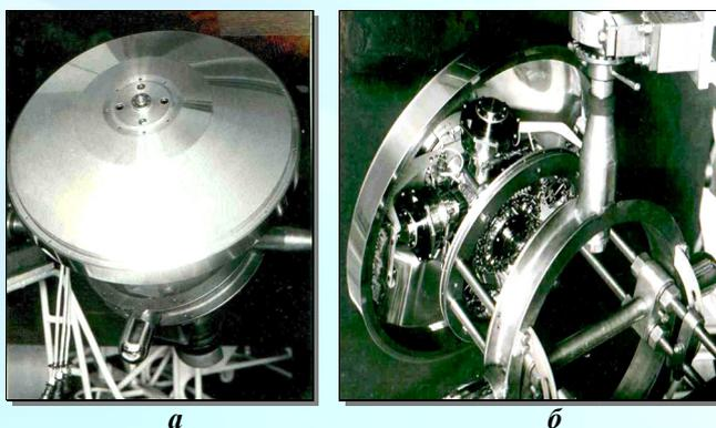
Гиросиловой стабилизатор ГСС КА «Молния»: а – общий вид; б – вид со снятым кожухом; максимальный кинетический момент – 100 Н·м·с; максимальный управляющий момент – 0,4 Н·м; частота вращения – 200 об/мин; потребляемая мощность – 15 Вт; масса – 85 кг
