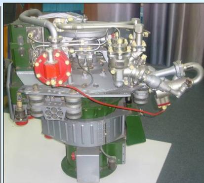
**Турбогенераторный блок бортовой системы электропитания ракеты Н1**
