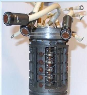
**Вращающееся контактное устройство (ВКУ):** момент инерции нагрузки привода –  $2 \text{ кг}\cdot\text{м}^2$ ; частота вращения привода –  $24 \text{ об/мин}$ ; точность поддержания частоты вращения –  $\pm 0,04\%$ ; количество токосъёмных цепей ВКУ –  $9$ ; ресурс –  $70 \cdot 10^6$  оборотов
