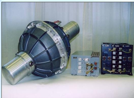
Двухступенной гиросиловой стабилизатор – гиросин: максимальный кинетический момент – 1000 Н·м·с; максимальный управляющий момент – 200 Н·м; угол прецессии – не ограничен; максимальный момент нагрузки привода прецессии – 200 Н·м; диаметр ротора – 0,4 м; частота вращения ротора – 10000 об/мин; удельная грузоподъёмность магнитных подшипников – 300 Н/кг; масса ротора – 40 кг; масса комплекта с электронной аппаратурой – 165 кг
