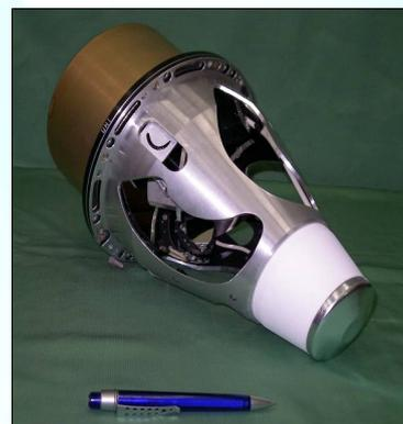
Построитель местной вертикали 8201-B: рабочий диапазон высоты полёта – 300 – 1200 км; линейный диапазон выходных характеристик не менее  $\pm 3^\circ$ ; суммарная погрешность не более 2,5 угл. мин; масса – 2,5 кг; энергопотребление – 5 Вт
