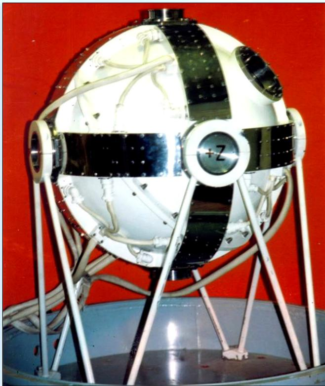
**Шаровой двигатель-маховик на магнитном подвесе:** максимальный кинетический момент – 250 Н·м·с; управляющий момент – 3 Н·м; диаметр ротора – 0,64 м; частота вращения – 800 об/мин; масса с аппаратурой управления – 230 кг
