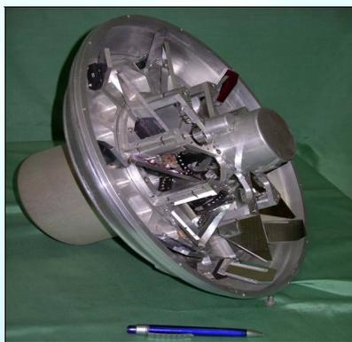
Инфракрасный построитель местной вертикали для малых КА: рабочий диапазон высоты полёта – (450 – 1300) км; линейный диапазон выходных характеристик – не менее  $\pm 3^\circ$ ; суммарная погрешность не более 2,5 угл. мин; масса – 15 кг; энергопотребление – 20 Вт
