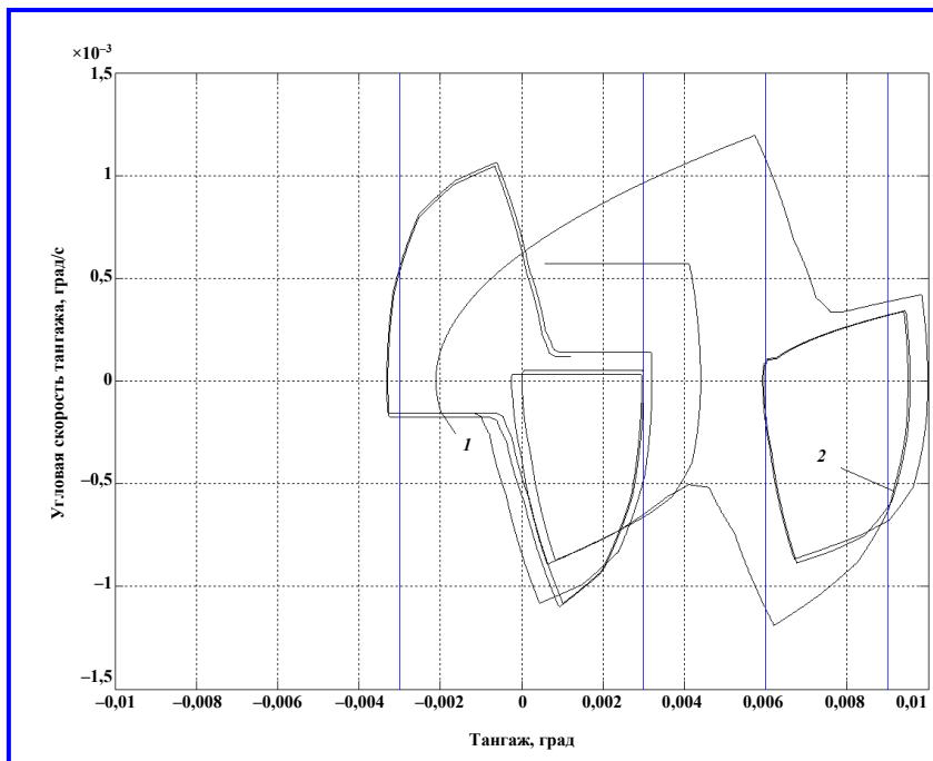
Рис. 8. Фазовый портрет колебаний в канале тангажа при включении КДУ (1 – начало работы КДУ; 2 – завершение работы КДУ; синим цветом проведены линии срабатывания АЦП)
