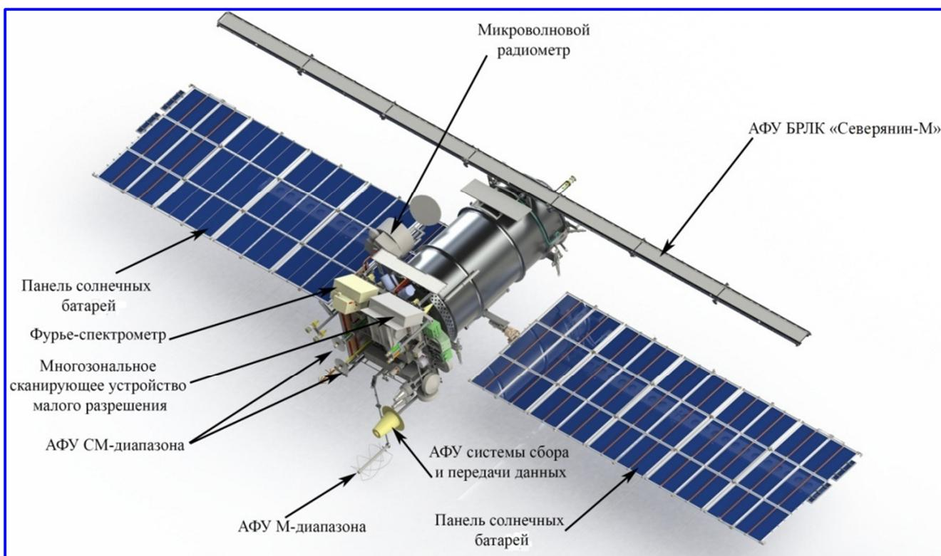
Рис. 3. КА «Метеор-М» № 2 в орбитальной конфигурации
