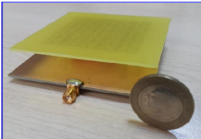
Рис. 5. Фотография антенны с поверхностным слоем из метаматериала
