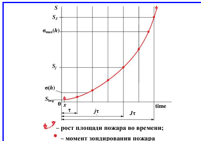
Рис. 4. Упрощенная схема обнаружения малоразмерного лесного пожара в j -й по счёту из моментов зондирования, которые чередуются с периодом \tau
