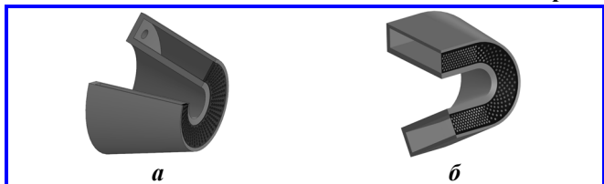
Рис. 12. Тороидально-конический источник заряженных частиц: a – газоразрядная камера кольцевой формы; б – газоразрядная камера комбинированной формы
