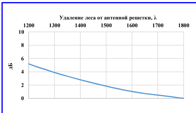
Рис. 8. Ослабления сигнала от радиолокационной станции в зависимости от расстояния R_0
