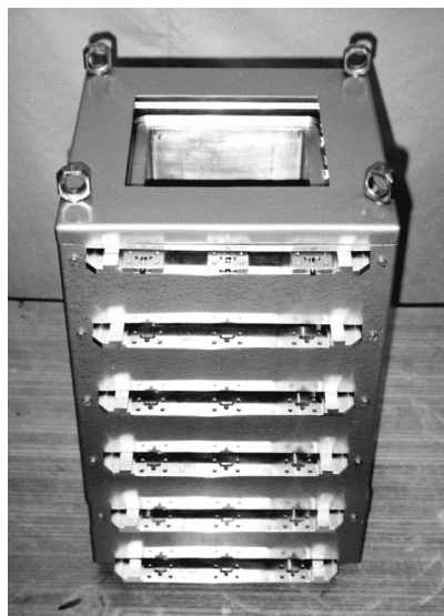
Рис. 3. Общий вид магнитной системы прибора
