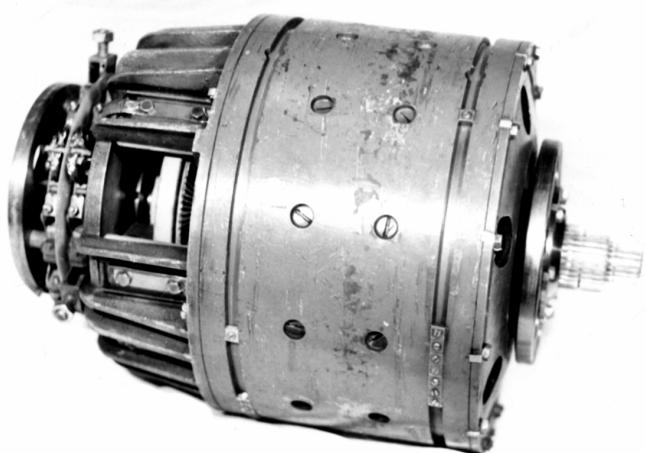
**Рис. 2. Коллекторный торпедный двигатель**
