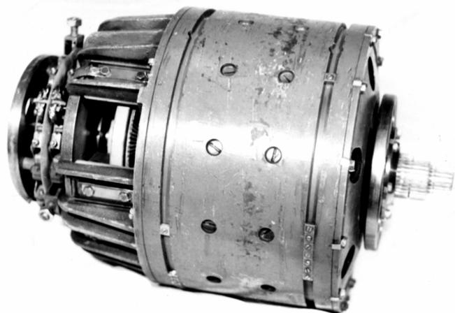
**Рис. 2. Коллекторный торпедный двигатель**
