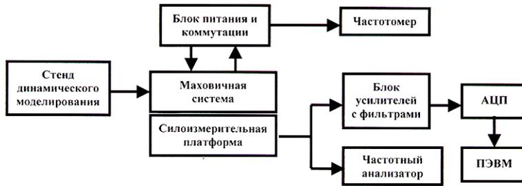
Рис. 2. Блок-схема стенда динамических испытаний
