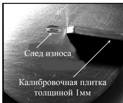
Рис. 4. След износа на диске
