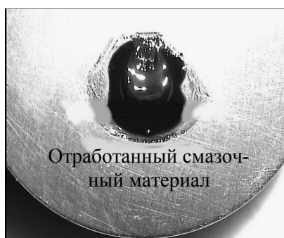
Рис. 3. Зона трения после проведения теста
