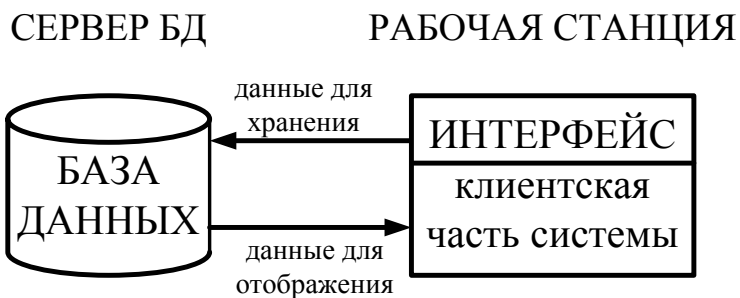
Рис. 5. Укрупненная схема сетевого варианта системы
