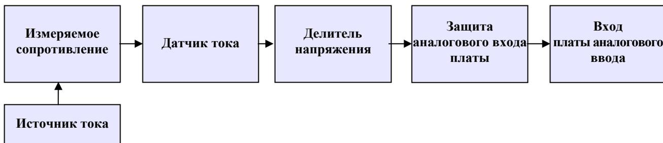
Рис. 7. Структурная схема модуля измерения сопротивлений
