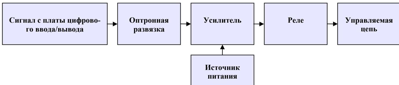
Рис. 3. Структурная схема модуля выдачи релейных команд
