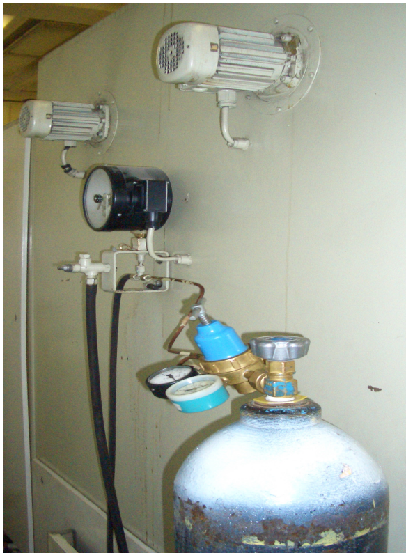
Рис. 2. Внешний вид стенда со стороны подключения баллона с осушенным газом и магистрали напуска
