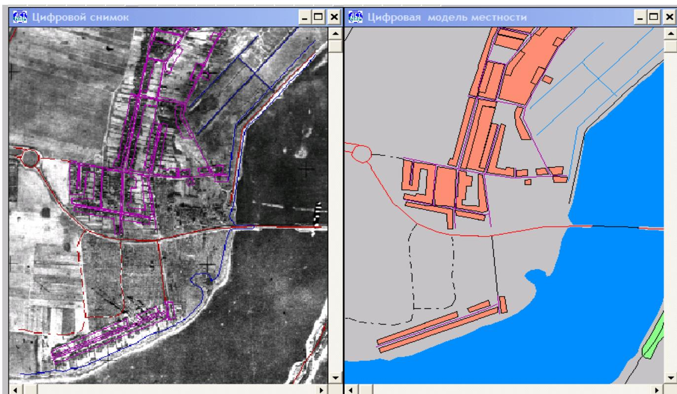
Рис. 7. Результат совмещения контурных объектов фрагмента ЦК с соответствующим участком ЦС
