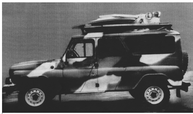
Рис. 3. Мобильная станция спутниковой связи на базе автомобиля УАЗ 3153-013
