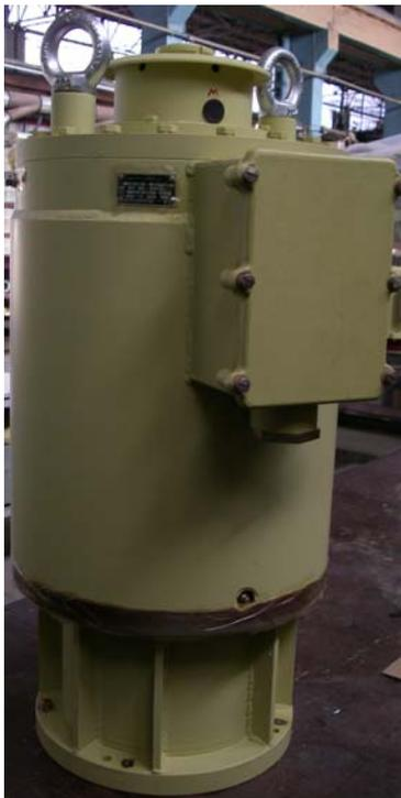
Рис. 4. Асинхронный двигатель ДАЗ7-2К
