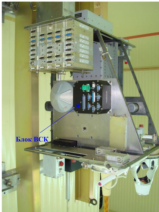
Рис. 3. Расположение блока ВСК на МКА
