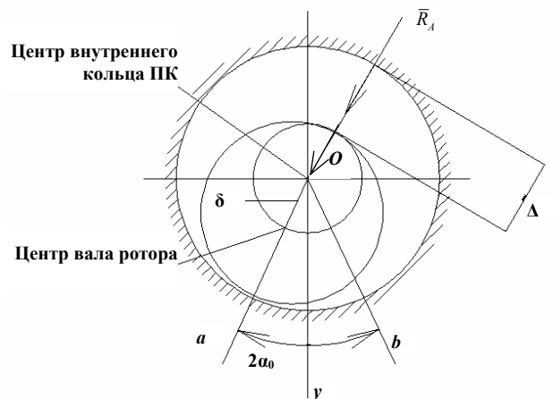
Рис. 3. Изменение положения центра вала ротора для первого режима
