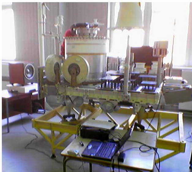
Рис. 3. Установка для проведения автономных испытаний динамического макета приборной платформы КА «Метеор-М» №1 методом акустического возбуждения
