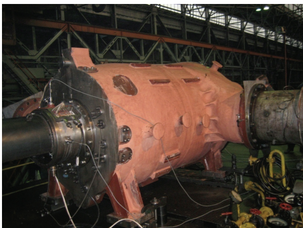
Рис. 10. Дожимной компрессор с ЭМП мощностью 16 МВт типа Н-498
