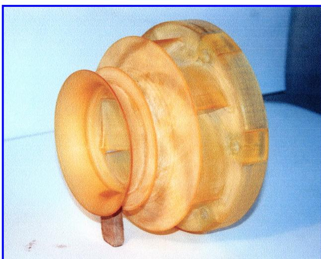
Рис. 2. Макет вентилятора В1 ММПП «Салют»
