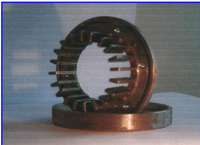
Рис. 1. Стальной вентилятор НПП ВНИИЭМ
