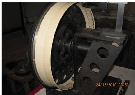
Рис. 11. Статор ДМ20-250/Г, установленный на имитаторе для проверки геометрии изделия
