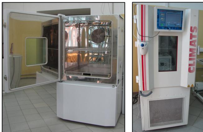
Рис. 12. Новое оборудование климатической лаборатории. Оборудование позволяет проводить испытания к воздействию повышенных и пониженных температур, влажности до 98%, ультрафиолетового излучения и агрессивной среды (сухая коррозия)
