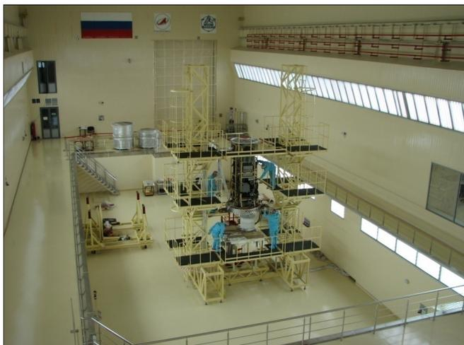
**Рис. 5. Главный зал сборки и испытаний больших КА в производственном МИКе**
