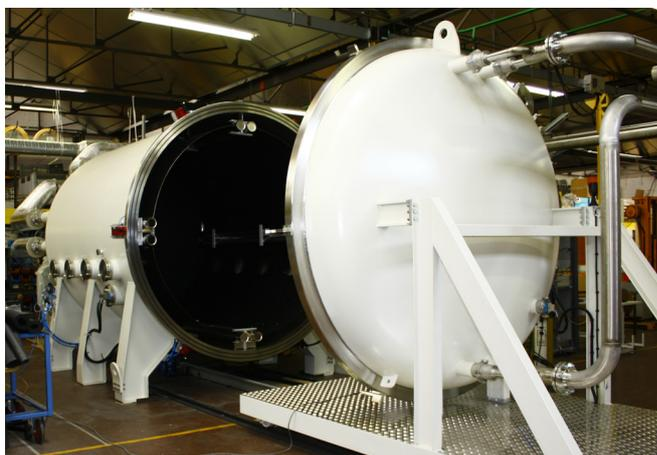
Рис. 11. Камера для термовакуумных испытаний МКА
