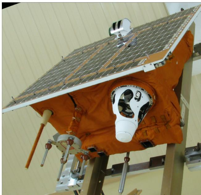
Рис. 1. Универсальная микроспутниковая платформа УМП-70
