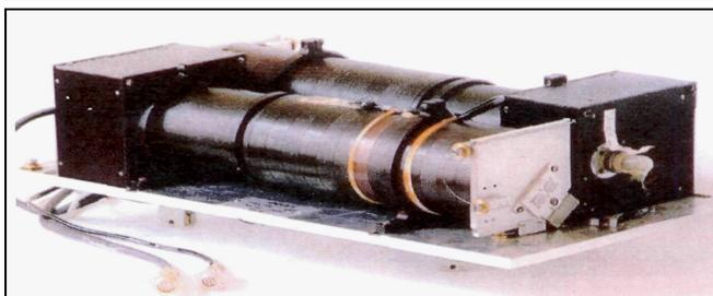
**Рис. 4. Оптический датчик для регистрации космического мусора**
