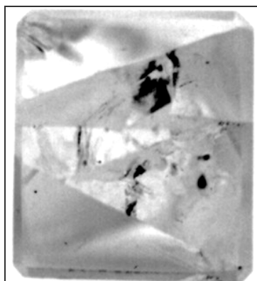
Рис. 5. Раскалывание оптического элемента по границам блоков под действием непрерывного лазерного излучения с плотностью мощности q \sim 50 \text{ Вт}\cdot\text{см}^{-2}
