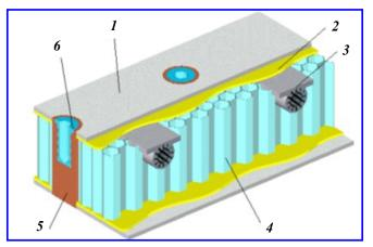
Рис. 1. Конструкция сотопанели: 1 – обшивка; 2 – плёночный клей; 3 – тепловая труба; 4 – сотопласт; 5 – самовспенивающийся клей; 6 – крепёжная втулка
