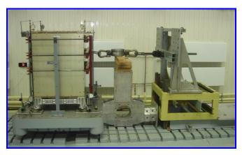
Рис. 2. Вид стенда статического нагружения с установленным динамическим макетом универсальной спутниковой платформы УКП-250
