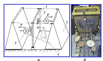
Рис. 6. Схема размещения несущей панели и измерительных индикаторов при радиальном нагружении (a): 1 – сотопанель; 2 – опора; 3 – индикаторы; 4 – динамометр; 5 – массогабаритные макеты блоков БА; вид на динамометры и индикаторы деформации (δ)
