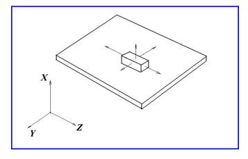
Рис. 5. Схема нагружения закладных элементов креплений на несущей панели
