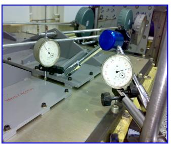
Рис. 7. Вид на динамометры и индикаторы деформации при тангенциальном нагружении несущей панели
