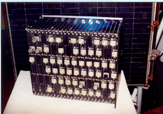
**Многофункциональное вычислительное устройство на микропроцессорной технике БУС. Использовалась на КА «Электро»**
