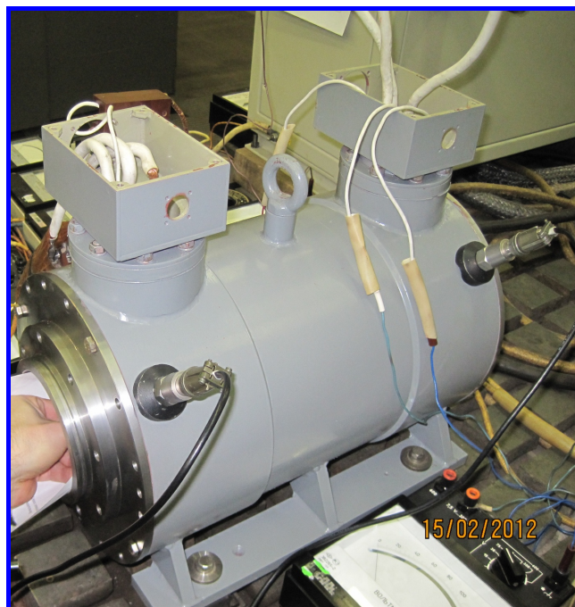
Рис. 6. Генератор 100 кВт, 60 000 об/мин
