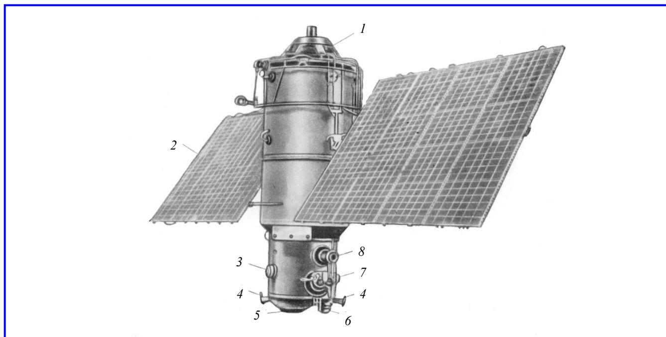
Рис. 1. Спутник «Метеор»: 1 – привод системы ориентации солнечных батарей; 2 – панели солнечных батарей; 3 – аппаратура контроля орбиты; 4 – антенны; 5 – телевизионные камеры; 6 – магнитометр; 7 – приёмное устройство актинометрической аппаратуры; 8 – приёмное устройство инфракрасной аппаратуры
