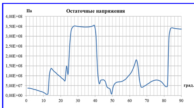
Рис. 9. Интенсивности напряжений по внутреннему радиусу клеммы. Ось Y – напряжения, Па. Ось X – угол, град
