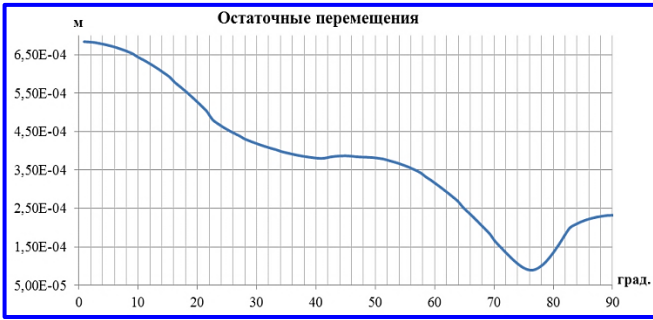
Рис. 10. Изменения остаточных перемещений по внутреннему радиусу клеммы. Ось Y – остаточные перемещения, м. Ось X – угол, град
