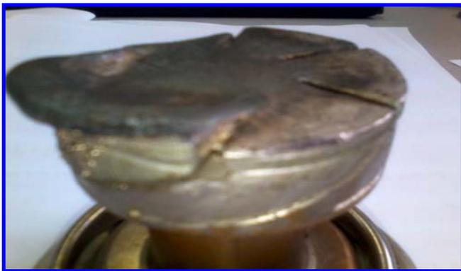
**Рис. 2. Типичная коагуляция контактной поверхности элемента контактной пары вакуумного выключателя (наглядная иллюстрация смещённого воздействия на контактную поверхность элемента)**
