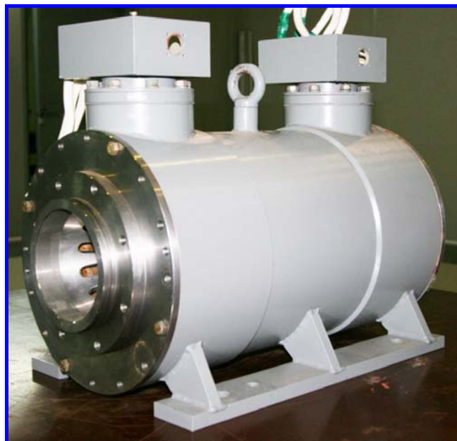
Рис. 1. Первый образец генератора 100 кВт, 60 000 об/мин
