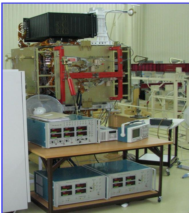
Рис. 5. Рабочее место оператора контрольно-проверочной аппаратуры КДУ
