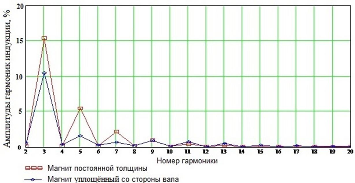
Рис. 5. Гармонические составляющие поля в зазоре СДПМ с гладким статором
