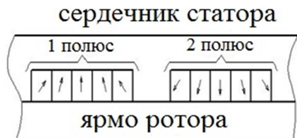
Рис. 22. Направления намагничивания магнитов двух соседних полюсов
