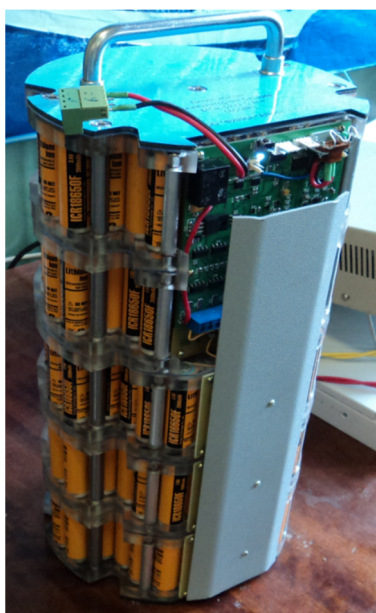
Рис. 4. Литий-ионная батарея на основе аккумуляторов габарита 18650 в конфигурации 58P6S (208 Вт·ч/кг) [14]
