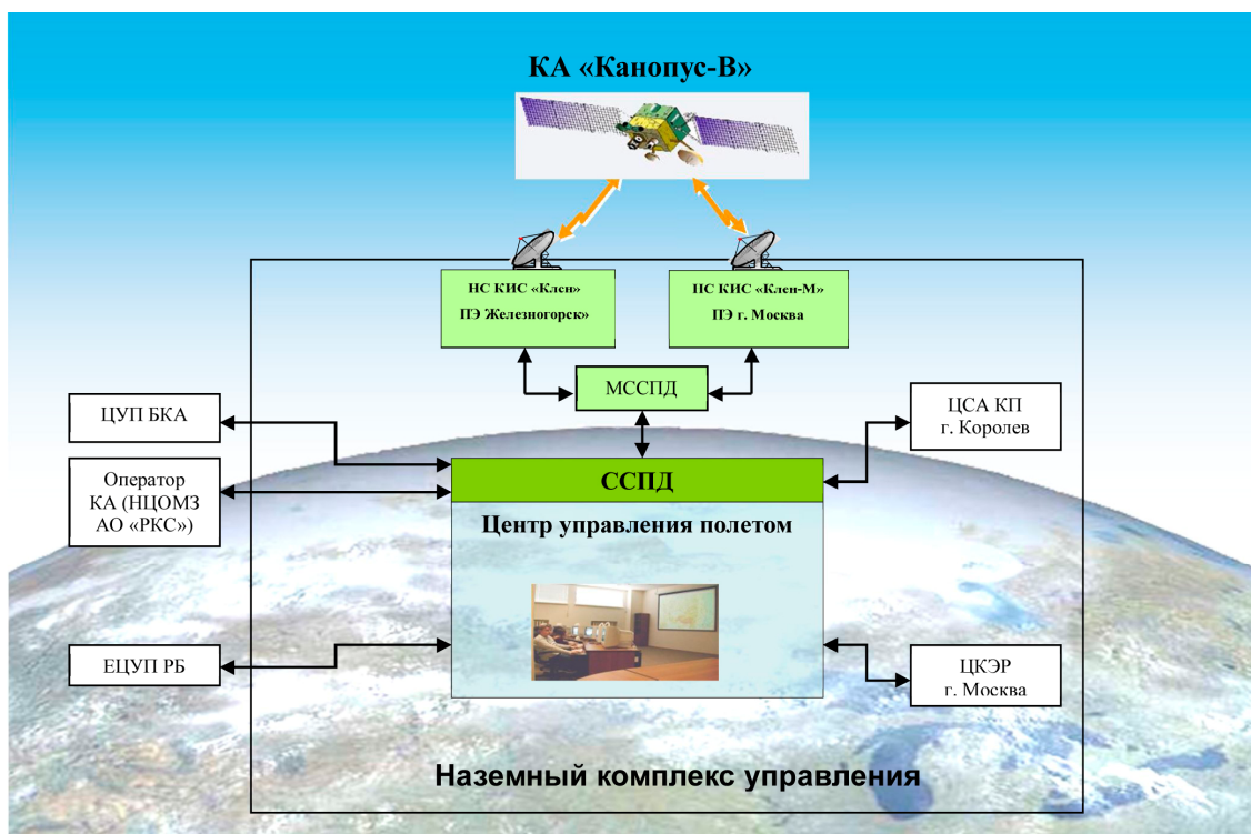
Рис. 1. Функциональная схема НКУ
