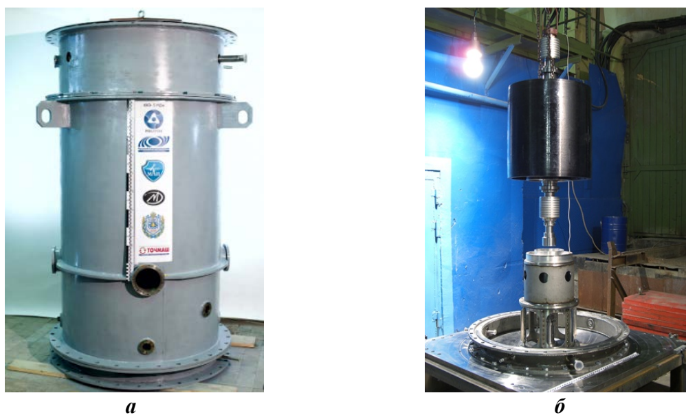
Рис. 10. КНЭ с величиной накапливаемой энергии 5 МДж: внешний вид (а); сборка основных узлов, монтаж маховика (б)
