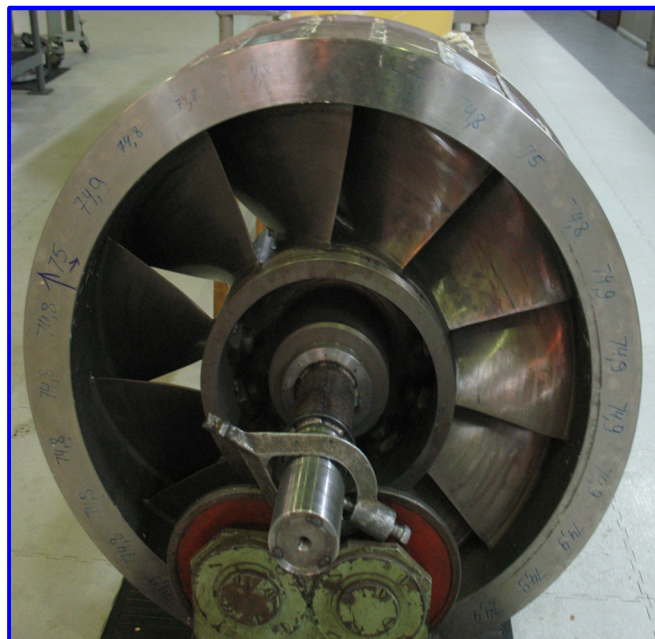
Ротор герметичного двигателя с рабочим колесом инновационного главного циркуляционного насоса
