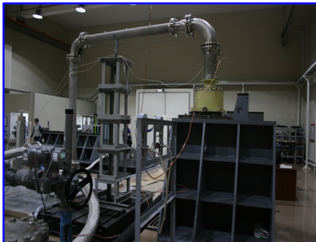
Рис. 5. Центр испытания насосного оборудования с испытываемым электронасосом типа ГЭН
