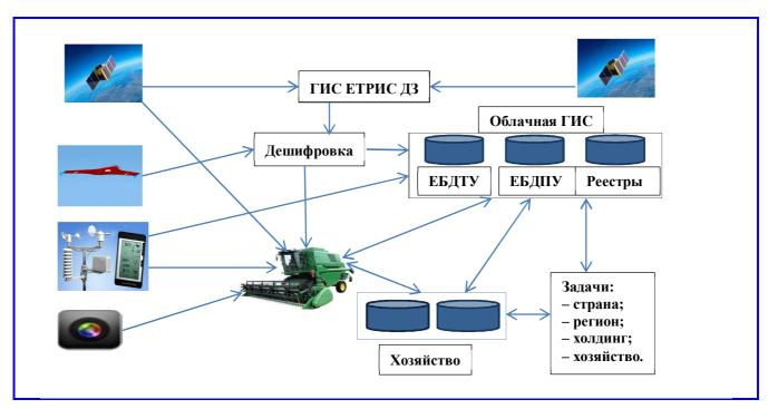
Рис. 4. Схема перспективной цифровой платформы применения геоинформационных систем в сельском хозяйстве
